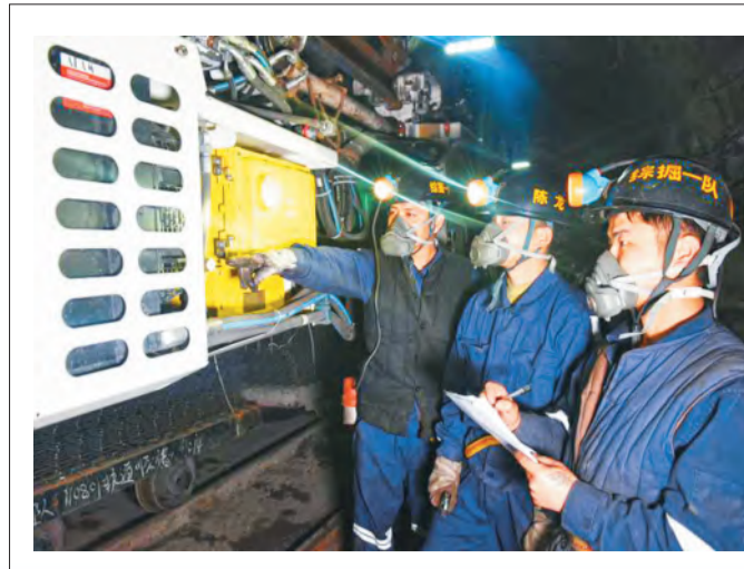
培养智慧矿山接班人 今年以来,板集煤矿工会采取“一徒多师、多专业教学、多岗位锻炼”的方式,向青工传授新思想、新技术、新知识,为智慧矿山培养接班人。图为该矿青工正在学习单轨吊吊钩维修技巧。 陈正飞 摄
