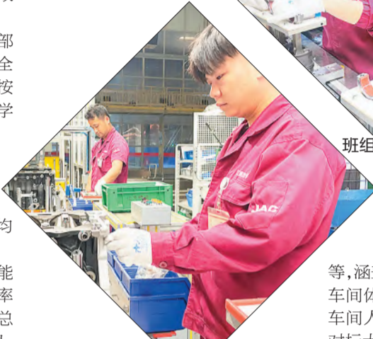
班组成员在安装机油泵
