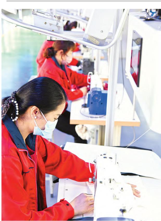
4月25日,合肥庐阳经开区奥瑞数控科技有限公司,员工对云版智能服装吊挂系统进行联机出厂测试。该系统依托其自主研发的云织造互联网平台,能精确地显示订单生产进度及每位员工的工作状态、工序、生产量等实时信息,助力生产经营管理。
